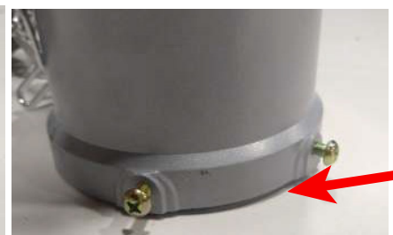
Img 2. Motor mal ensamblado.
