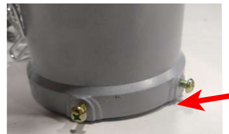
Img 2. Motor mal ensamblado.
