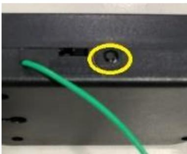
Deprima la Tecla LEARN (marcada en la imagen) durante poco mas de 1 segundo hasta que el LED rojo se apague, luego deprima cualquier boton del transmisor que desea cargar, durante un segundo, hasta que el LED parpadee indicando que el procedimiento está OK.
